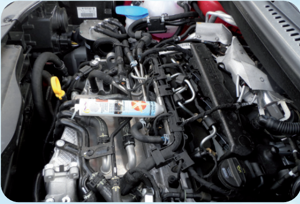
Weber-Isis®-Universal-Aktivator Montage im Motorraum an der Dieselleitung eines VW Caddy.
