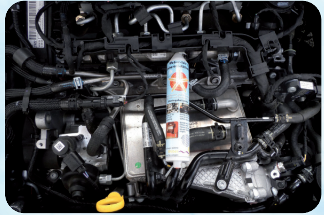
Weber-Isis®-Universal-Aktivator Montage im Motorraum an der Dieselleitung eines VW Caddy (andere Ansicht).
