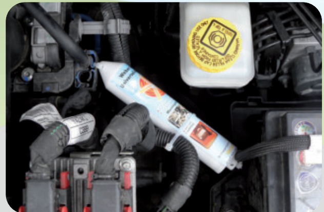
Weber-Isis®-Universal-Aktivator Montage im Motorraum an der Benzinleitung eines Fiat Punto (andere Ansicht).
